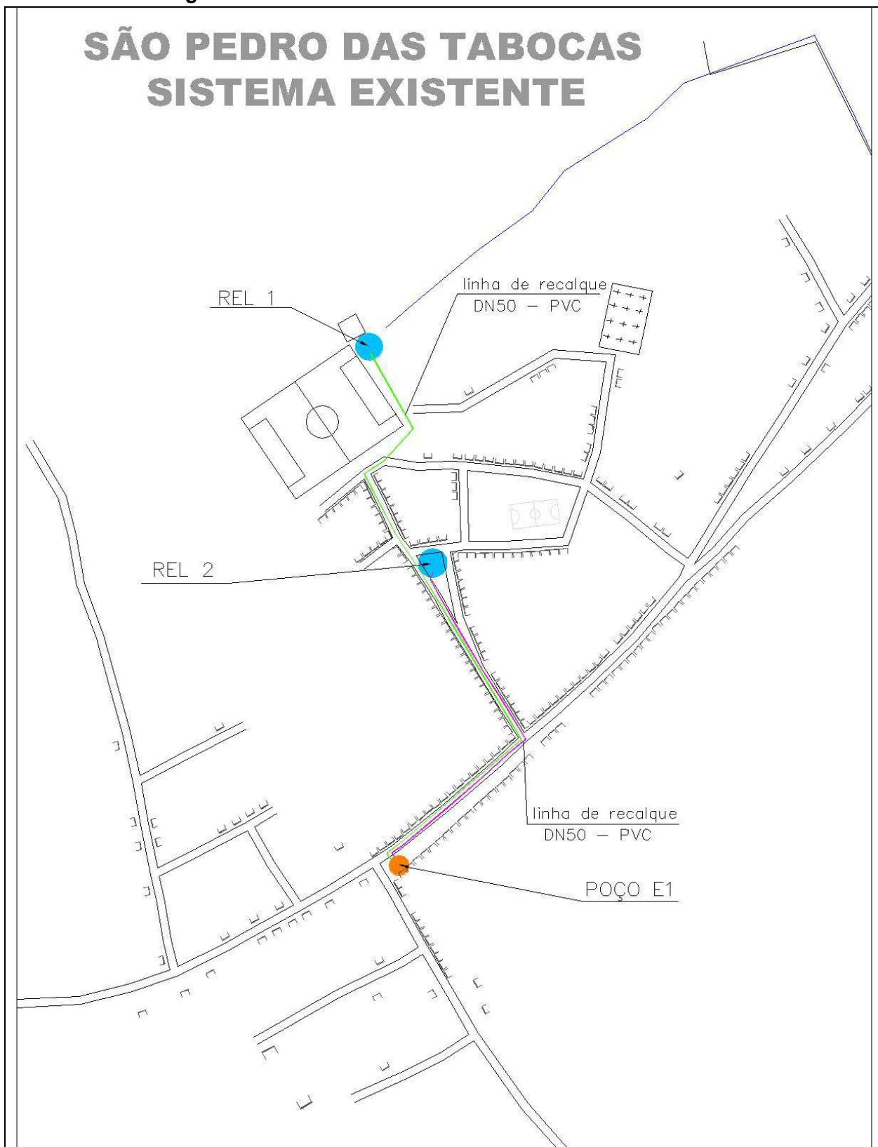
Figura 02 – Sistema existente de São Pedro das Tabocas
